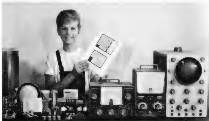
Bild 11. Die Heath-Meß- und Prüfgeräte sind betriebsfertig und als Bausatz zum Selbstbau lieferbar. Links die Einzelteile eines Bausatzes; rechts betriebsfertig ein Dekaden-RC-Generator, Modell AG 9 A, ein Röhrenvoltmeter, Modell IM-10, und ein Breitband-Oszillograf, Modell 0-12/S
